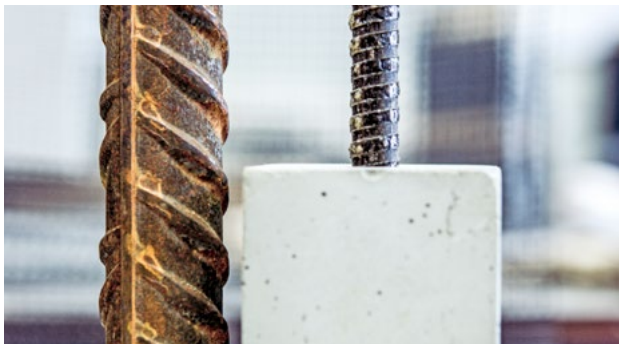
Armierungen aus Carbon sind deutlich dünner als herkömmliche Stahlarmierungen.
