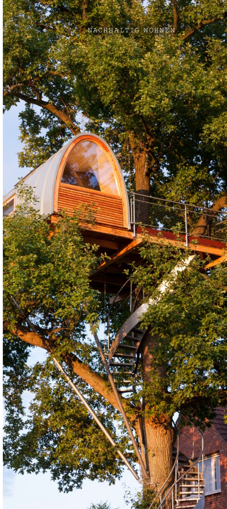
Das Baumhaus Around the Oak in Halle Westfalen wird über die Dachluke einer alten Scheune erschlossen. Von hier windet sich eine Wendeltreppe aus Edelstahl um die Eiche und zwischen Ästen hindurch zur Luke bis in elf Meter Höhe hinauf.
